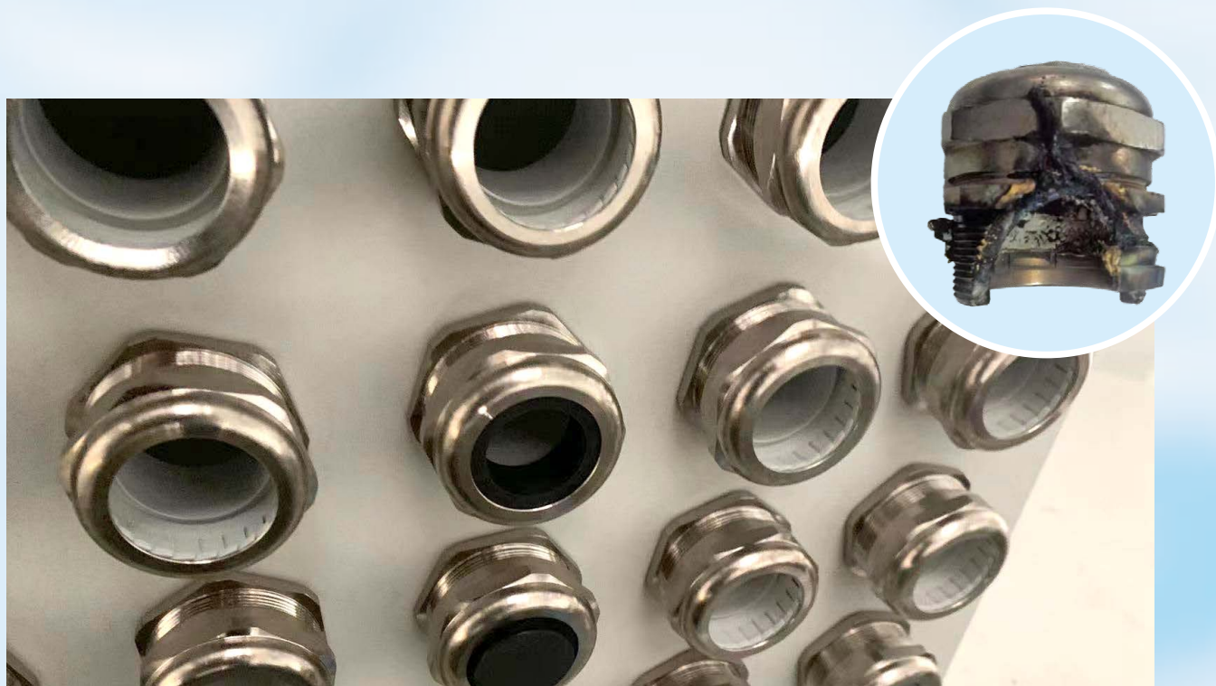
传统花瓣结构易压伤电缆、破损电缆，导致绝缘失效起火
